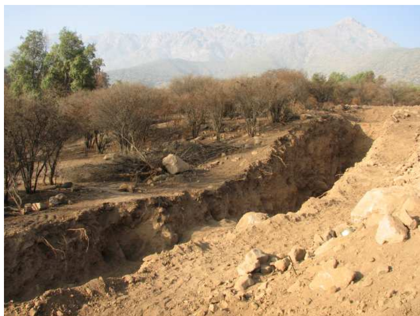
Figura.3. Fotografía de la trinchera norte. Se aprecia el escarpe de falla que produce un escalón, o salto topográfico, en la superficie del terreno.
